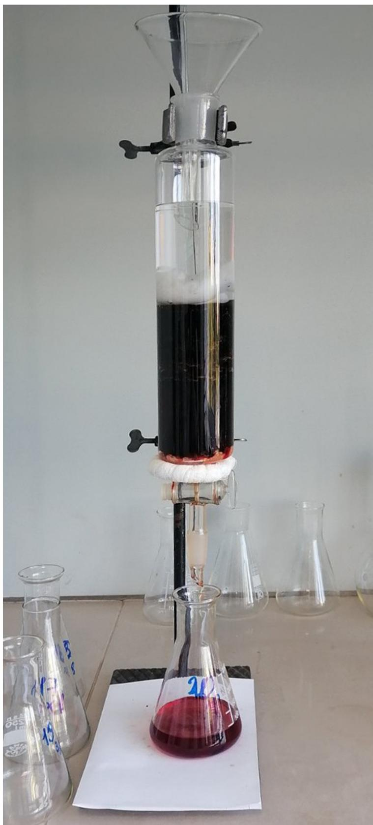
Рисунок 10 — Процесс хроматографического деления извлечения из хвойного экстракта
