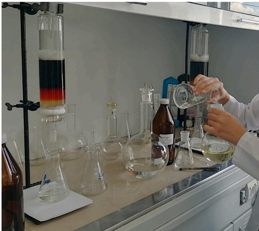
Рисунок 8 — Рабочий процесс хроматографического деления субстанций, используемых для получения гелей
