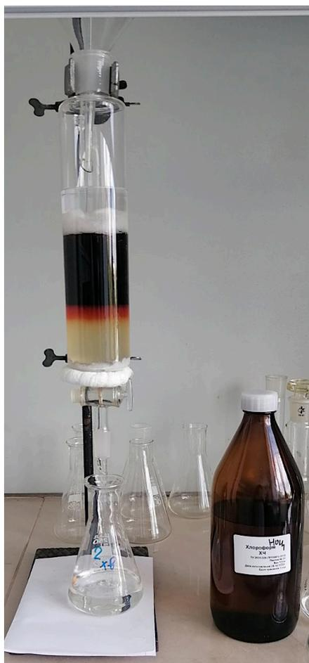
Рисунок 21 — хроматографического деления извлечения из хвойного экстракта
