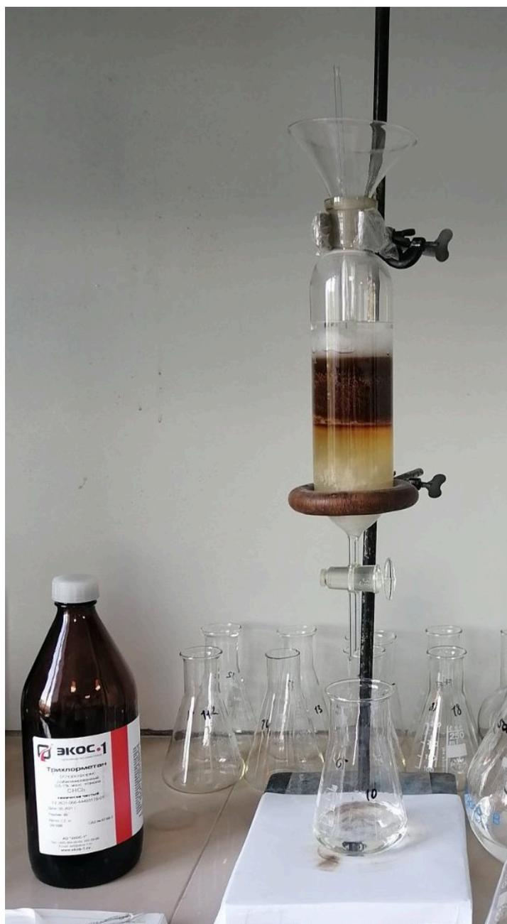
Рисунок 11 — Процесс хроматографического деления извлечения из экстракта коры осины
