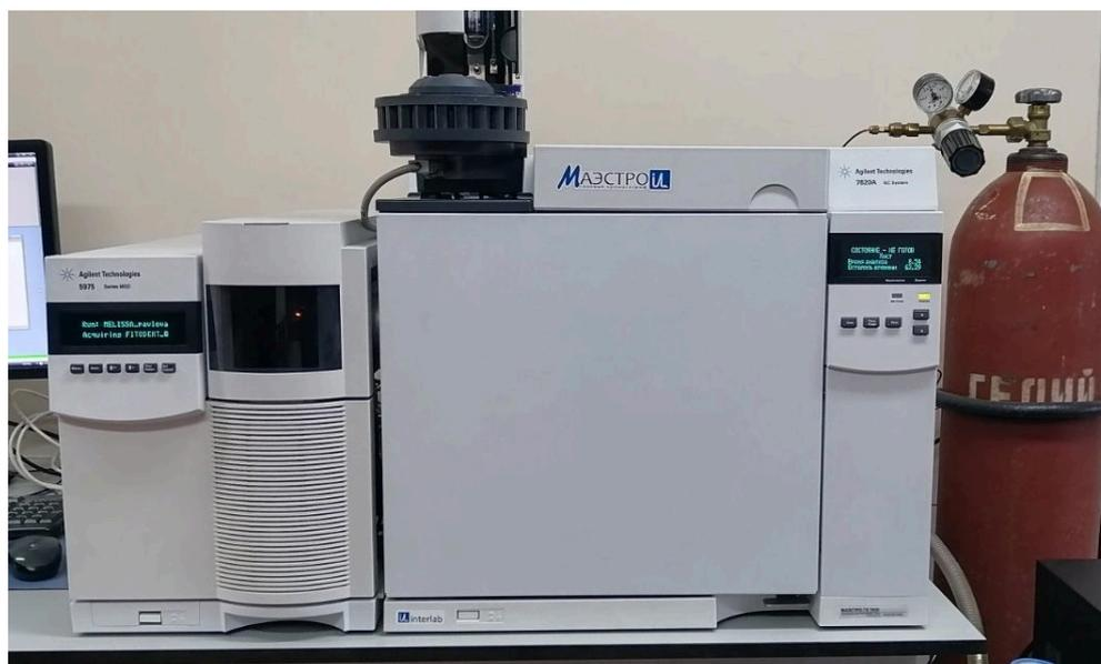
Рисунок 13 — Газовый хроматограф «МАЭСТРО 7820» с масс-спектрометром модели Agilent 5975 и автоинжектором
